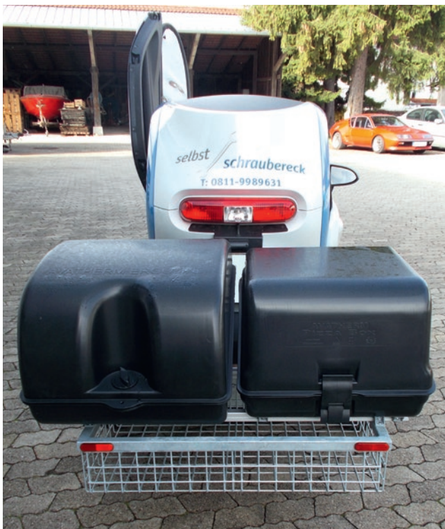
Doppelboxsystem* mit Ergoline- oder Pizzabox auf Träger, Lichtleiste und Kennzeichenhalter optional (ohne Abbildung)
